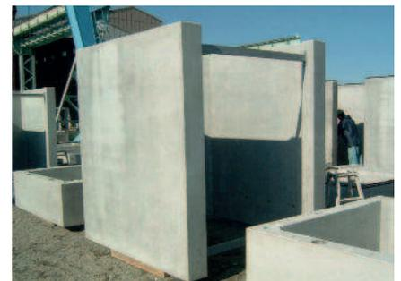
O poço de elevador pré-moldado é transportado para a obra dividido em duas unidades
