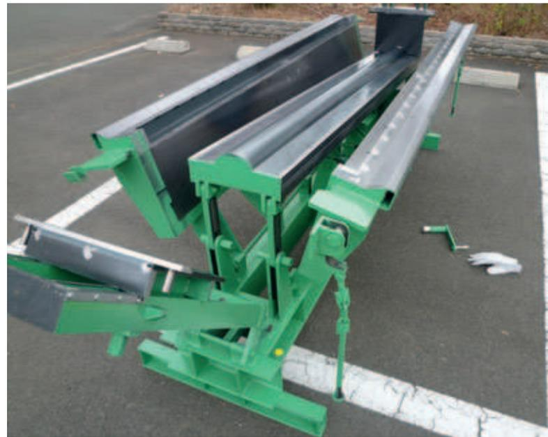
Fig. 2, 3: Encofrado para una pendiente de ajuste variable
