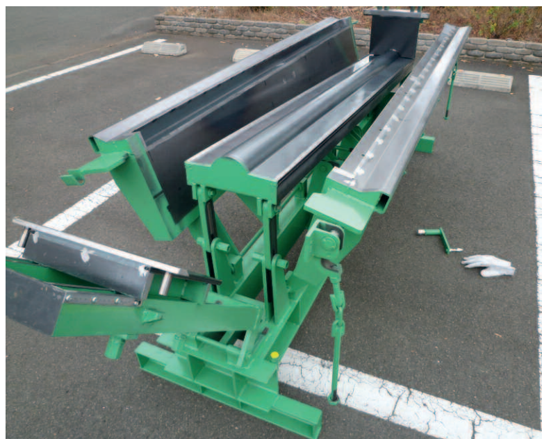
Рис. 2, 3: Благодаря градуировке размеров в форме, безошибочный переход с одной толщины на другую и смена направления уклона не составляет труда
