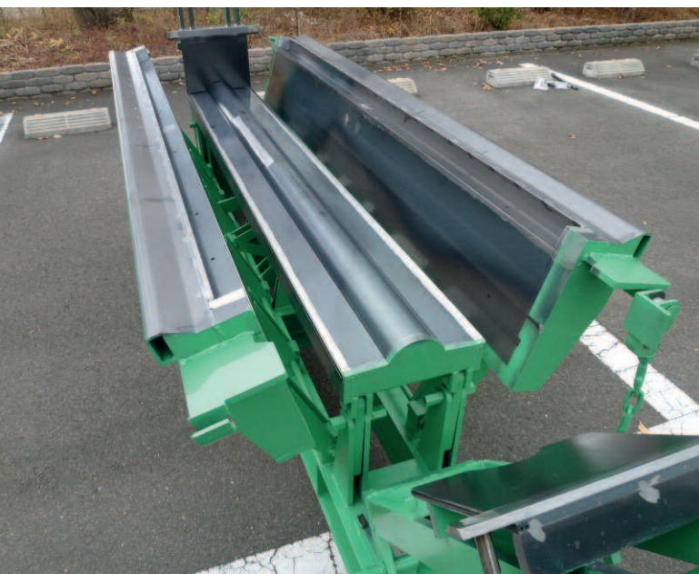
Рис. 2, 3: Благодаря градуировке размеров в форме, безошибочный переход с одной толщины на другую и смена направления уклона не составляет труда
