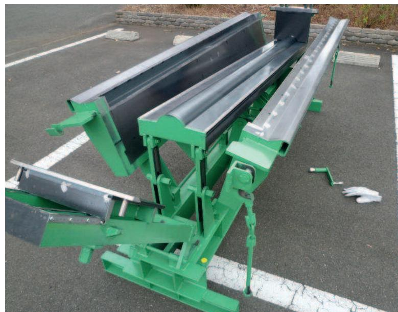
Fig. 2, 3: Uma vez que as dimensões são realizadas no próprio molde, as mudanças em espessura são fáceis, é fácil evitar erros e mudanças no ângulo do declive também são possíveis
