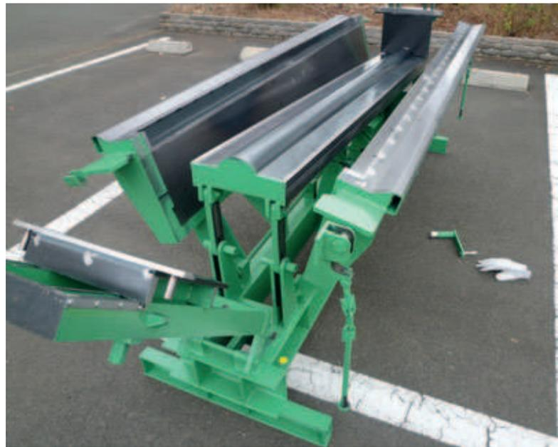
Abb. 2, 3: Schalung für variabel einstellbares Gefälle
