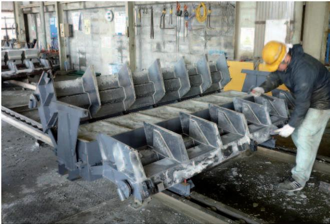
Блоки, изготовленные при помощи форм Toyota Forms, легко обслуживает один работник
