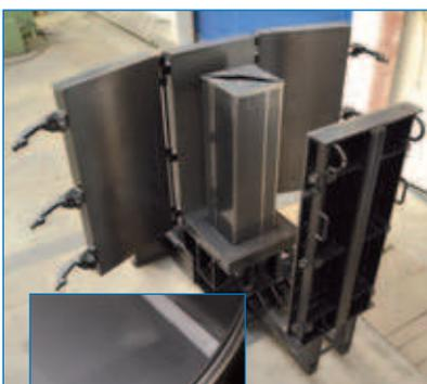
*Toyota-Schalung im Detail: gut erkennbar der schrumpfbare Innenkern und die präzisen Verschlüsse. Durch hochwertige Schalungprofile ist die Schalung sogar wasserdicht!*
