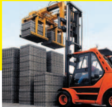
Kaldırma ve taşıma makinesi STAZ-DZ II – çift paketli beton yapı elemanları için akılcı eleçleme.
