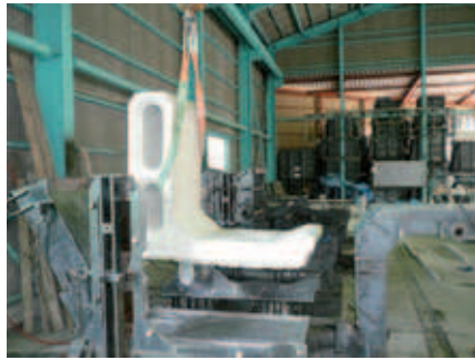
Toyotaforms kalıplarının üretildiği üretim tesisi Şek. 9 Kalıptan çıkarma işlemi
