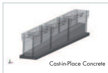
Fig. 3b: Pendiente variable para esta solución de hormigón in situ
