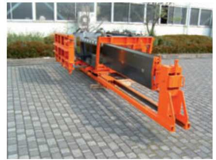
Şekil 3: İç karot, kayar ray düzeneği ile bir taraftan asılıdır.
