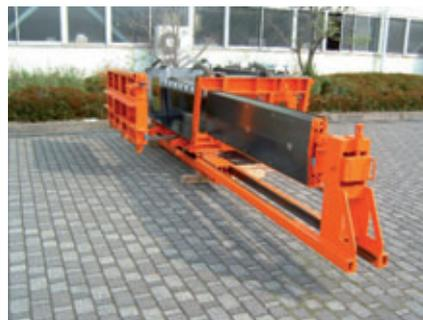
Fig. 3: El núcleo del encofrado se introduce por un lado con un carro
