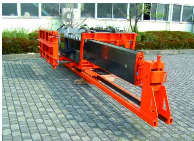
Рис. 3: Сердечник навешен с одной стороны на скользящий рельс
