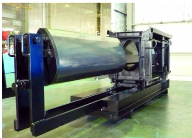
Рис. 2: Форма с откатным сердечником
