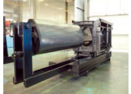
Fig. 2: Molde com núcleo central do tipo rebaixável
