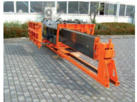
Fig. 3: O núcleo central é suspenso de um lado com um trilho deslizante
