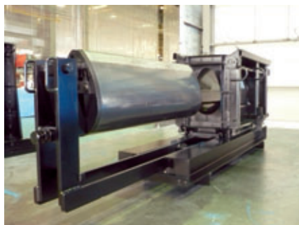
Abb. 2: Schalung mit ausziehbarem Schalungskern
