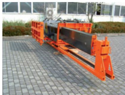
Abb. 3: Der Schalungskern wird von einer Seite her auf einem Schlitten eingeführt
