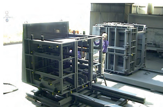
Рис. 7: Сдвижная опалубка для опорной стены „Road L”
