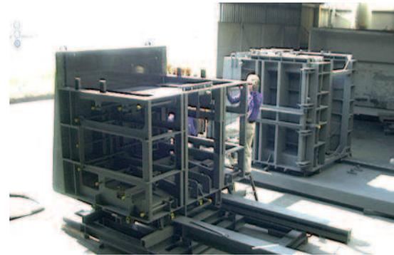
Fig.7: Molde ajustável para o muro de arrimo Road L
