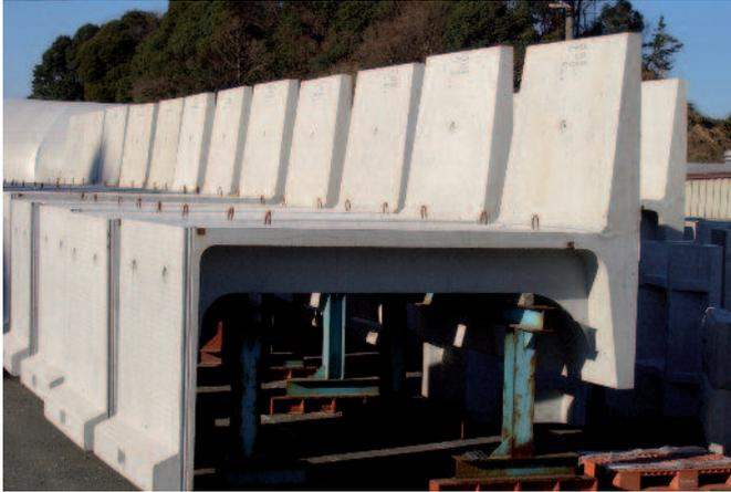
Fig. 1: a Road L é utilizada para alargar estradas estreitas
