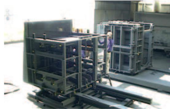
Fig. 7: Cassaforma regolabile per il muro di contenimento 'Road L'
