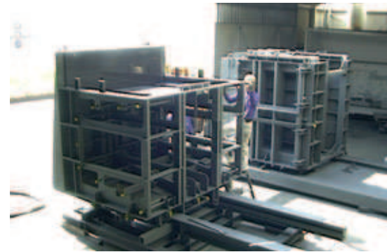
Abb. 7: Verstellbare Schalung für die „Road L“-Stützmauer
