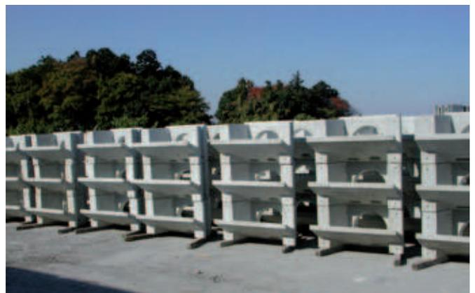
Bloques de muros de contención en el almacén
