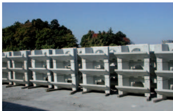
Элементы подпорных стенок на складе
