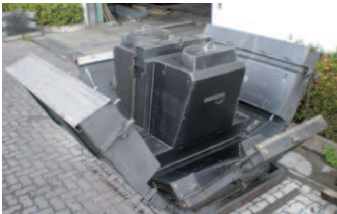
Form für die Stützmauerelemente
