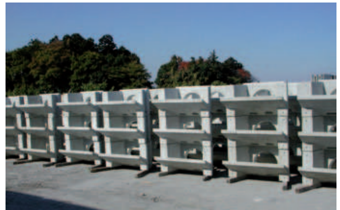
Stützmauerelemente im Lager
