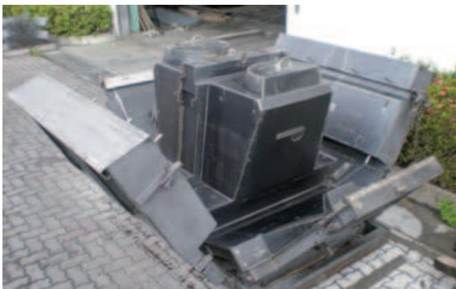
Moule pour éléments de murs de soutènement
