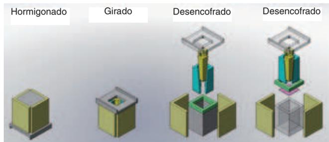
Uno de los métodos de desencofrado con núcleo de encofrado sin adelgazamiento cónico
