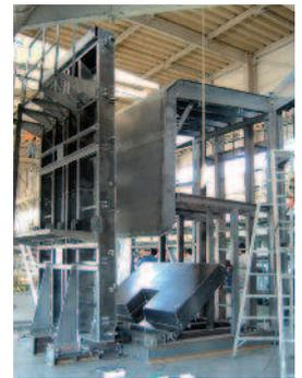
Fig. 3a, 3b: Exemplos de moldes de parede de contenção usados no Japão
