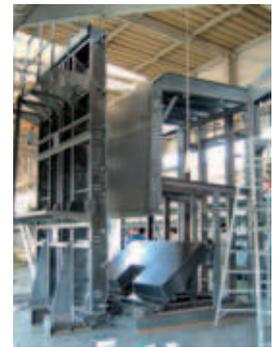
Abb. 3a, 3b: Beispiele für in Japan verwendete Stützmauerschalungen
