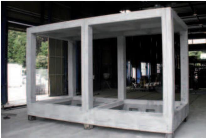
Fig. 3: Servicios prefabricados de hormigón en la fábrica
