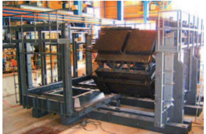
Fig. 4: Molde/encofrado para fabricar los servicios prefabricados de hormigón
