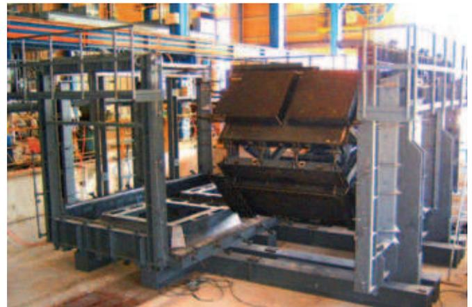
Fig. 4: Stampo/cassaforma per la prefabbricazione in calcestruzzo di servizi igienici
