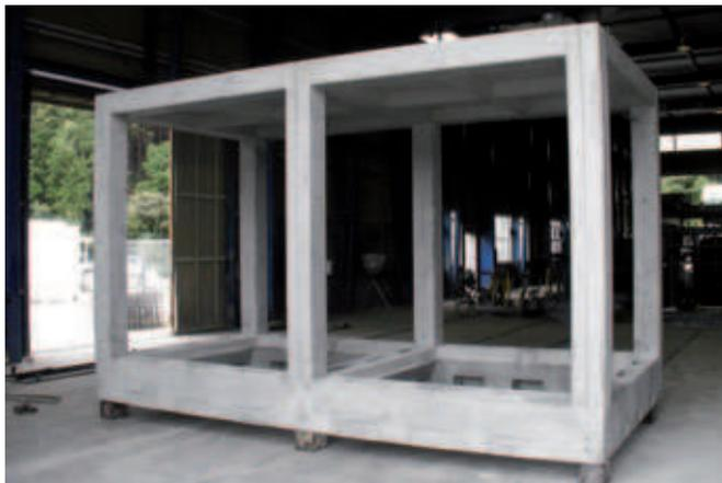
Fig. 3: Servizi igienici prefabbricati in calcestruzzo nello stabilimento di prefabbricazione
