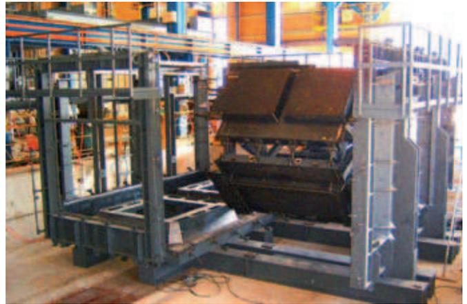
Ill.4: Moule / coffrage d'élément préfabriqué en béton pour la fabrication de l'installation sanitaire préfabriquée.
